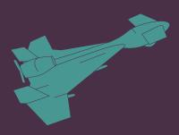
Este misil de permanencia en vuelo o "loitering" (merodeo) de 2,1 m se lanza desde un vehículo de tierra. Está equipado con una ojiva con 15 kg de explosivos. El Harpy puede permanecer en vuelo en modo merodeo por hasta 9 horas cada vez, en busca de señales de radares enemigos. Detecta y ataca emisores de radar enemigos automáticamente, destruyéndolos al volar hacia el objetivo y detonarse.
